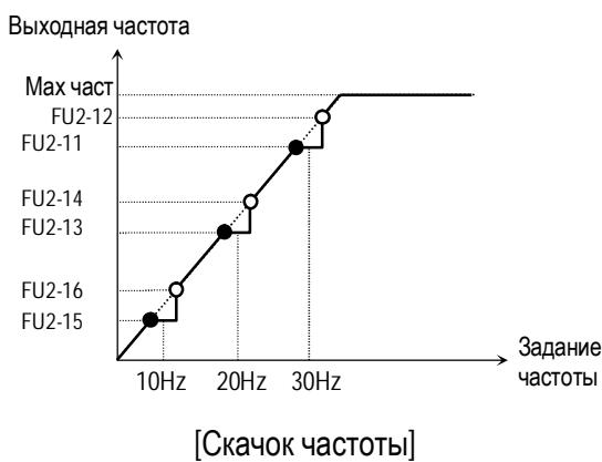
☞ **Примечание:** если заданная частота установлена внутри вырезанного диапазона, то выходная частота преобразователя равна нижней частоте скачка.
