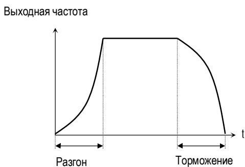
[Характеристика разгона/торможения: «U-типа»]
